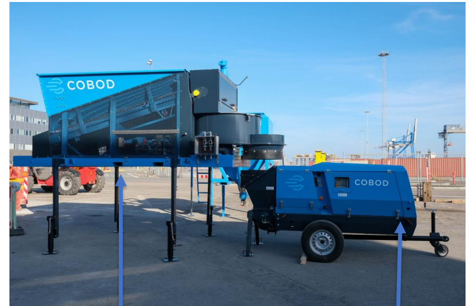
Concrete mini batch plant (mixer)
